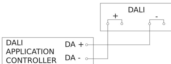
Schéma de câblage pour la mise en réseau DALI-2 APC & DALI-2 IPD
